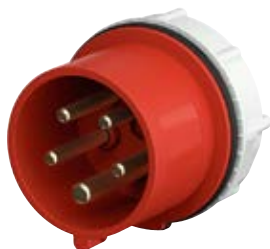
相位转换插头RAPID0 用于直径为70 mm的墙孔, 中心固定, 客户需提供一鼻状挡块以支撑连接器的铰链翻盖, 确保达到满意的紧固效果
